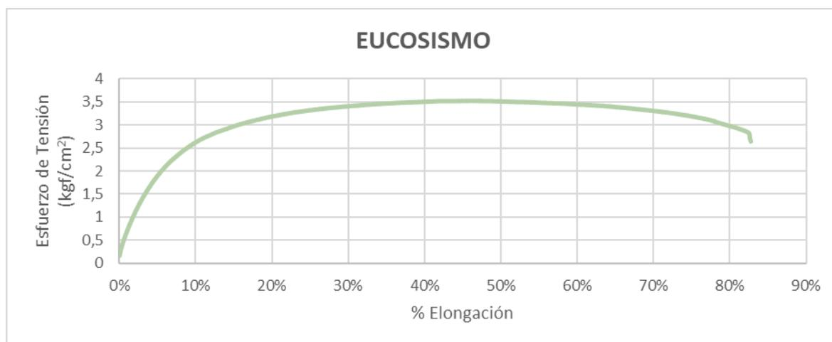
\***NOTA:** Ensayos realizados sobre el material puro, sin diluir y con un tiempo de curado de 30 días. Basado en la norma ASTM D-2370 con probetas, dimensiones, condiciones de ambiente y equipo de falla ajustados al tipo de material.
