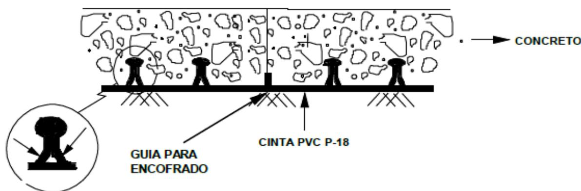
La fabricación de piezas de conexión y las uniones entre tramos se realizan haciendo cortes que sean necesarios, luego se enfrentan las partes a soldar y se pegan mediante ablandamiento del material por calor mediante aire a una temperatura de 140°C aproximadamente, lográndose así prolongar su longitud, formar ángulos diversos o empalmes de tramos.
