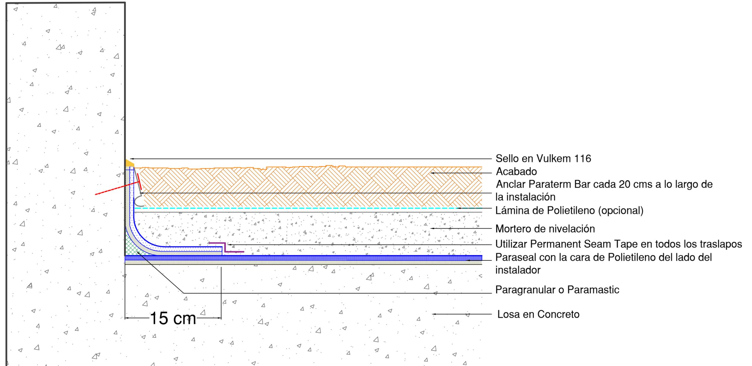
Nota: Los productos de la línea Paraseal requieren un mínimo de 140 kg/m<sup>2</sup> de compactación/confinamiento para obtener los resultados esperados.
