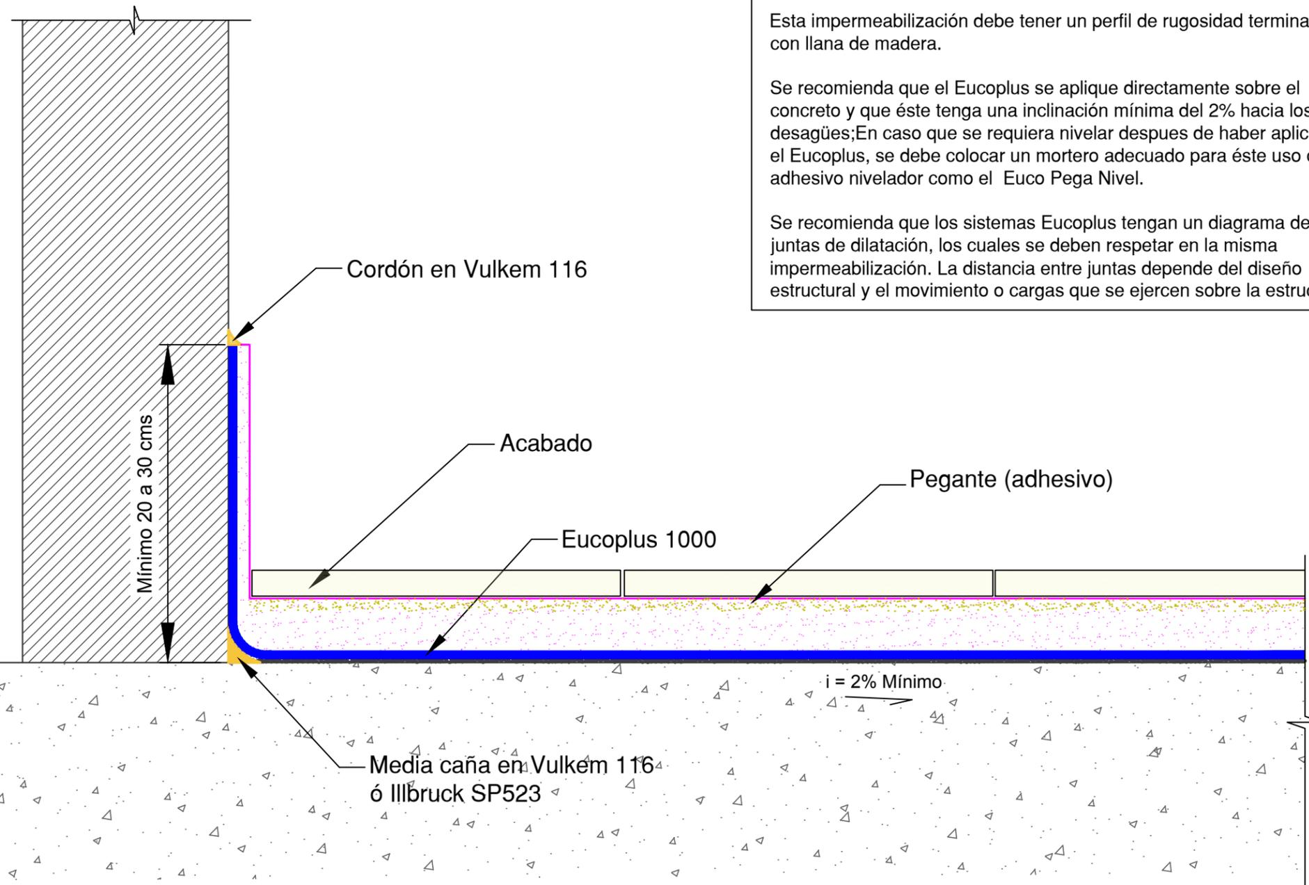
Nota: En el caso de enchapes, su instalación se puede iniciar 4 horas después de haber aplicado la impermeabilización con Eucoplus.
