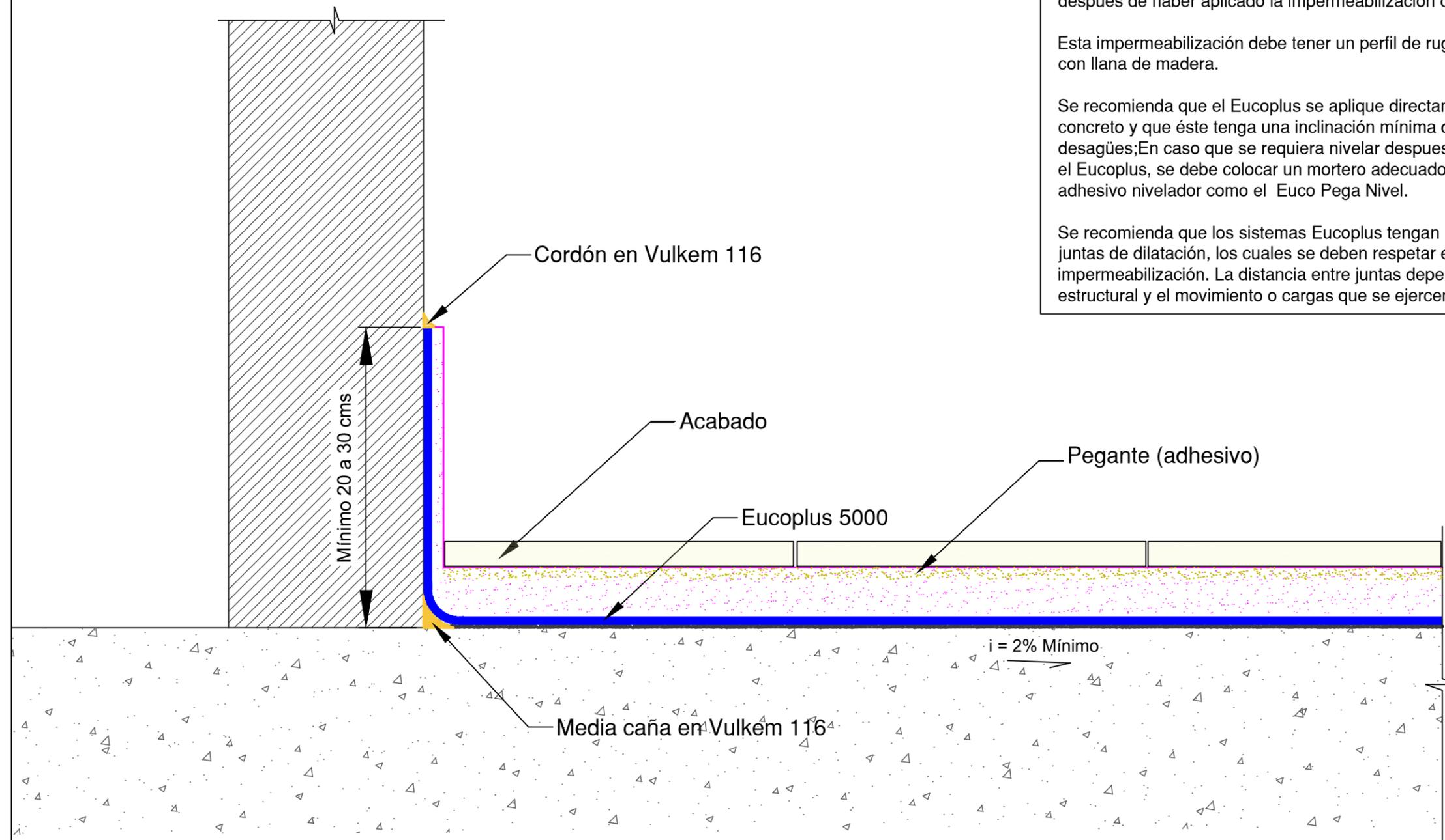
Nota: En el caso de enchapes, su instalación se puede iniciar 4 horas después de haber aplicado la impermeabilización con Eucoplus.
