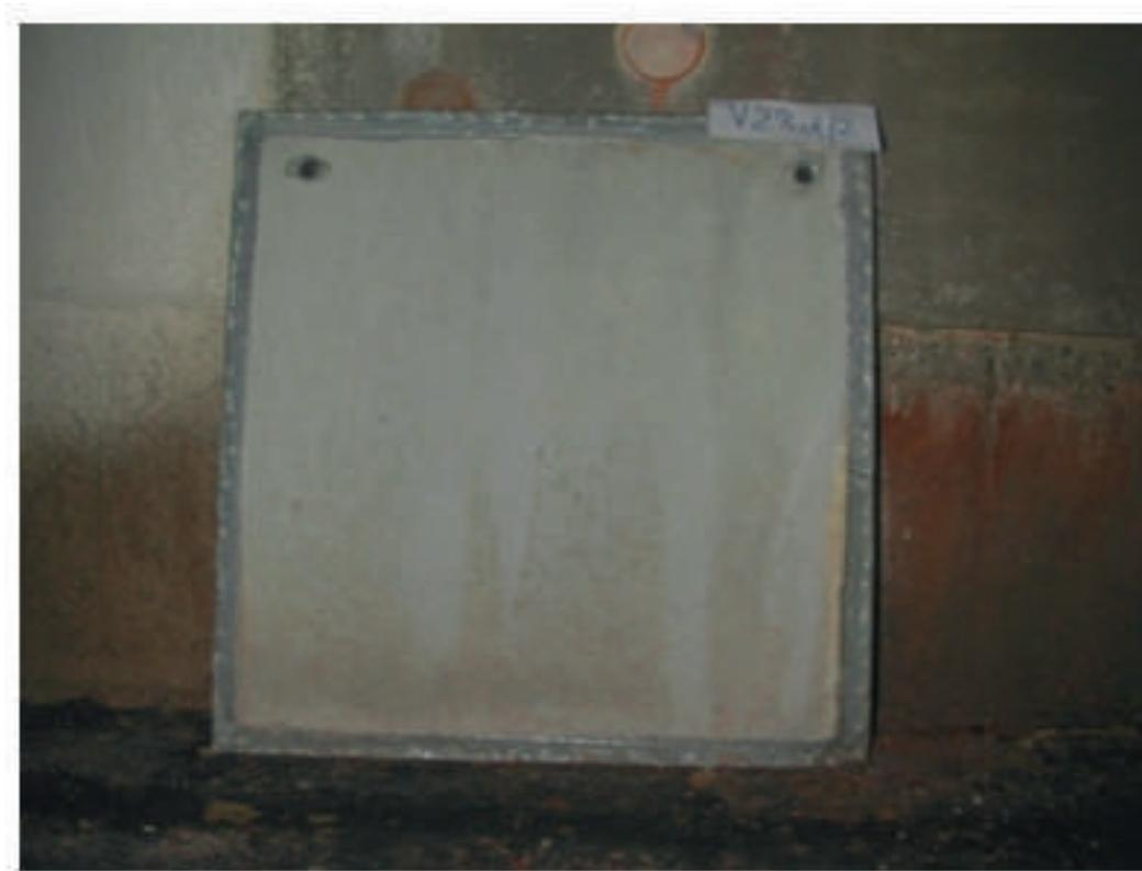
Muestra recubierta con POLYZEM Z modificado con polímeros después de la exposición a la zona de gas de  $H_2S$  del tanque de sedimentación final de la planta de tratamiento de aguas residuales Pro Rheno Basilea, Suiza.
