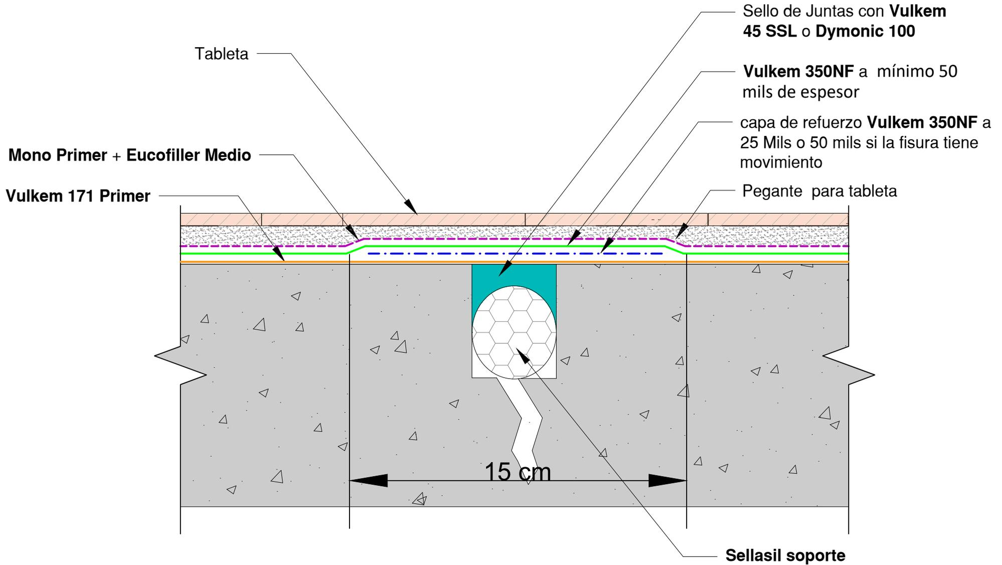
TRATAMIENTO DE FISURAS MAYORES a 1,6 mm con SISTEMA VULKEM 350 + MONO PRIMER + EUCOFILLER MEDIO
