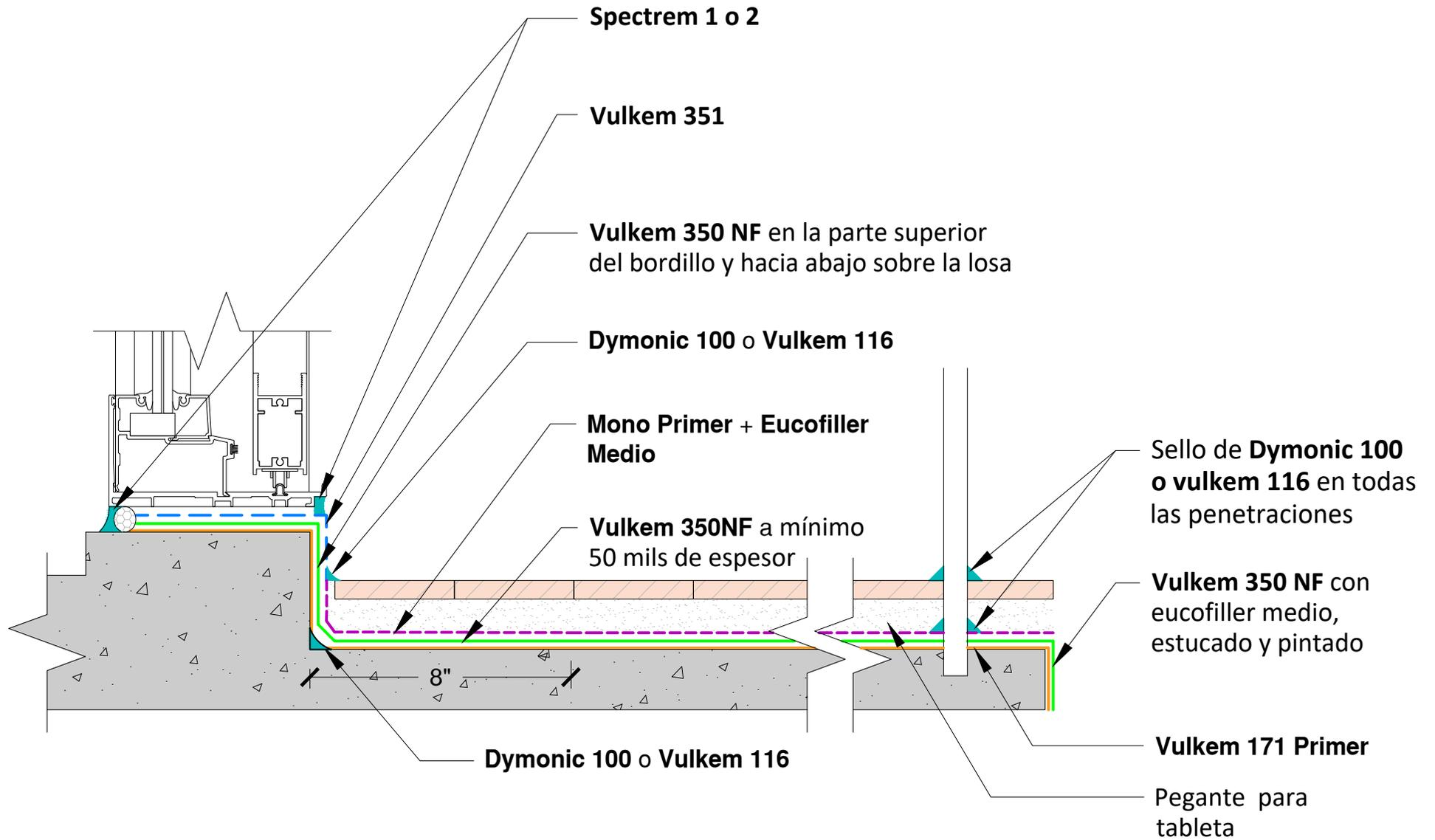
DETALLE TRATAMIENTO DE PUERTA CORREDIZA Y PENETRACIONES EN BALCÓN CON SISTEMA VULKEM 350 + MONO PRIMER + EUCOFILLER MEDIO
