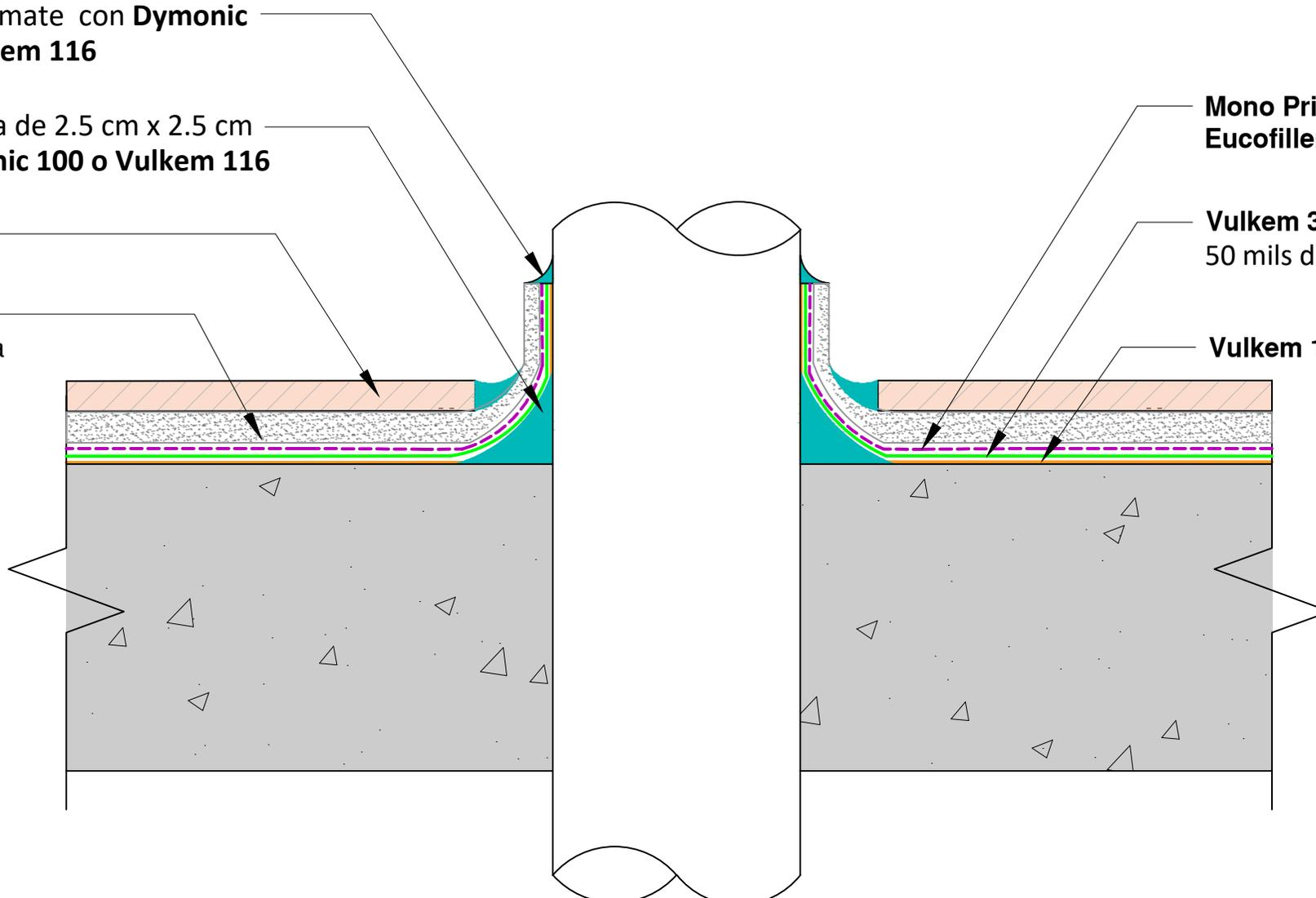
DETALLE TRATAMIENTO DE PENETRACIONES SISTEMA VULKEM 350 + MONO PRIMER + EUCOFILLER MEDIO
