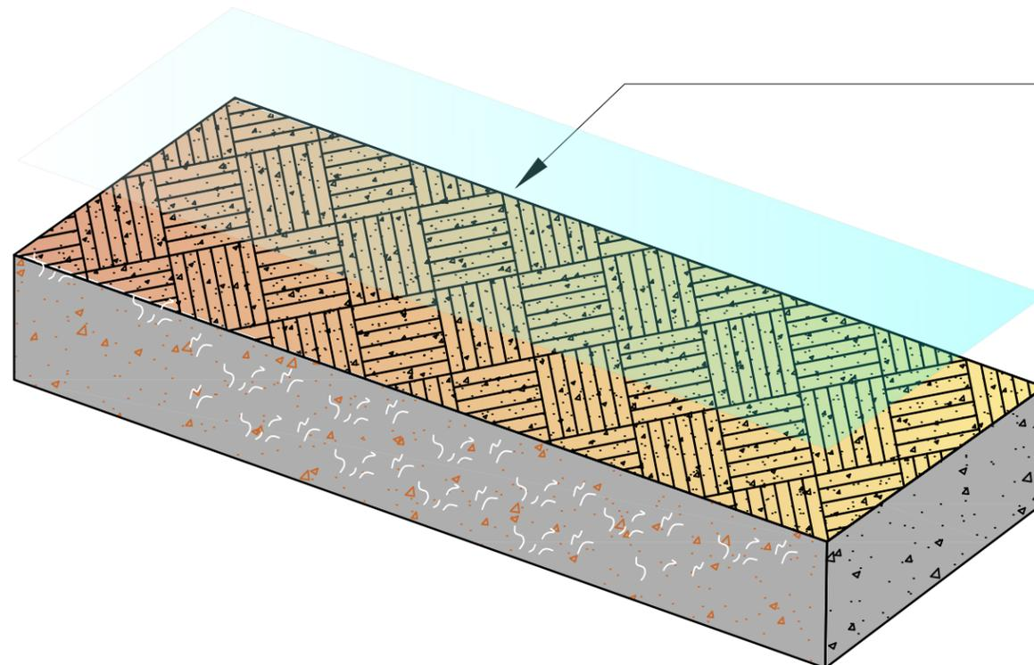
El proceso de sellado con **CLEAR SEAL** de INCRETE SYSTEMS se realiza con el fin de proteger el concreto estampado, se puede efectuar la aplicación con rodillo de cerdas cortas y resistente a solventes logrando la mayor protección de la superficie, asegúrese de no dejar ninguna marca del rodillo
