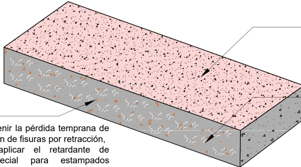
Con el fin de prevenir la pérdida temprana de agua, y la formación de fisuras por retracción, se recomienda aplicar el retardante de evaporación especial para estampados **INCRETE DELAY**
