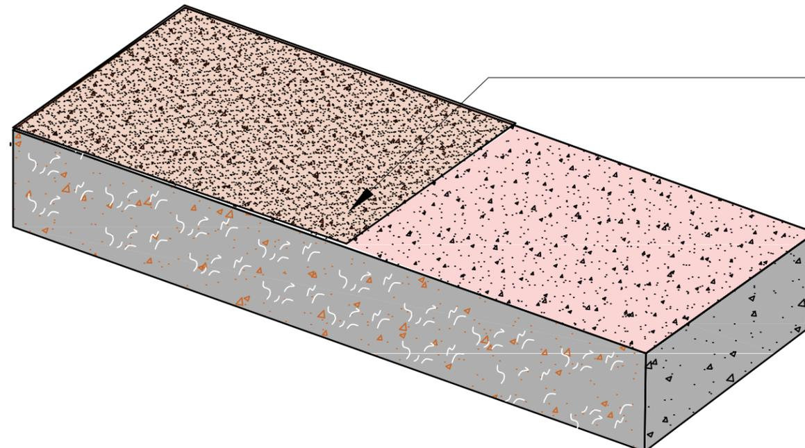
**COLOR HARDENER** La aplicación del endurecedor cumple dos funciones, dar el color primario al concreto estampado y aumentar la resistencia a la abrasión de la superficie, por lo cual se considera una etapa clave para obtener un estampado durable y con una excelente apariencia
