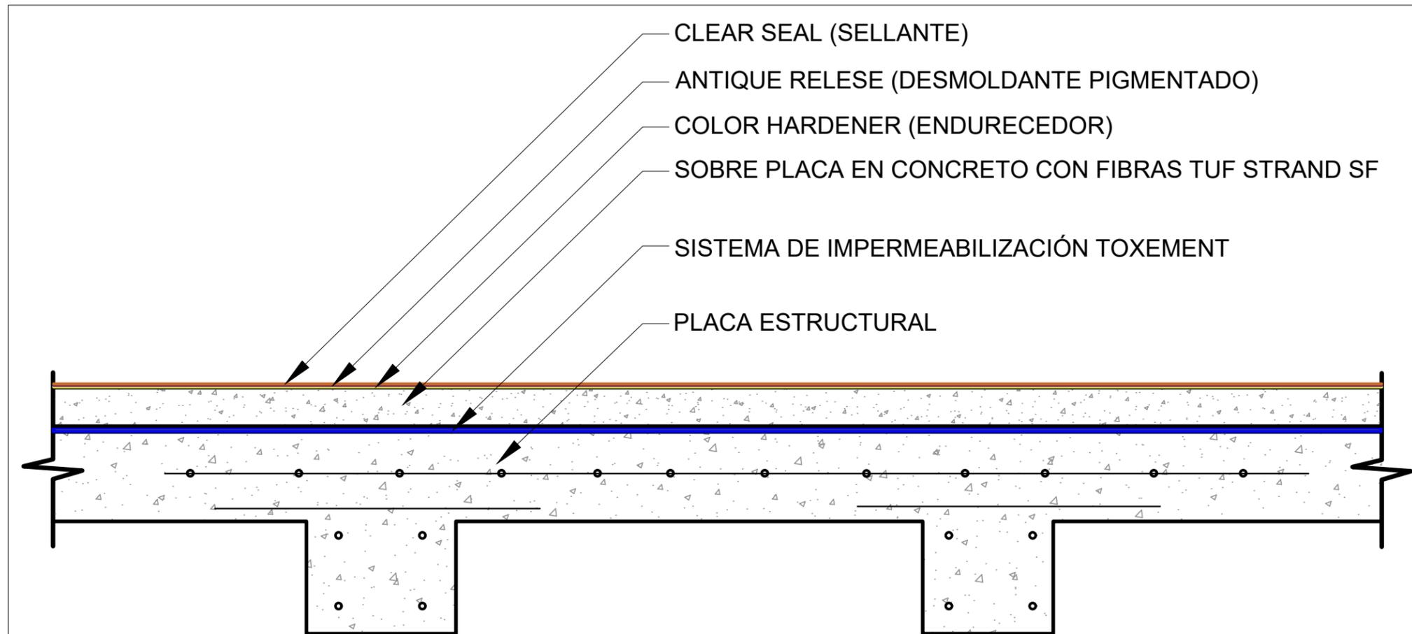
DETALLE IMPERMEABILIZACIÓN Y SOBRE PLACA
