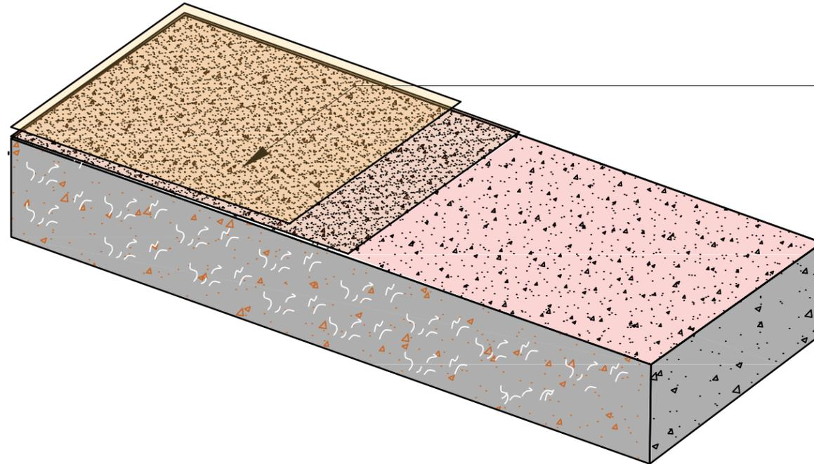
El uso del desmoldante cumple dos funciones dentro del proceso de estampado, dar el color secundario para lograr apariencia natural en el concreto estampado y evitar la adherencia de los moldes al concreto
