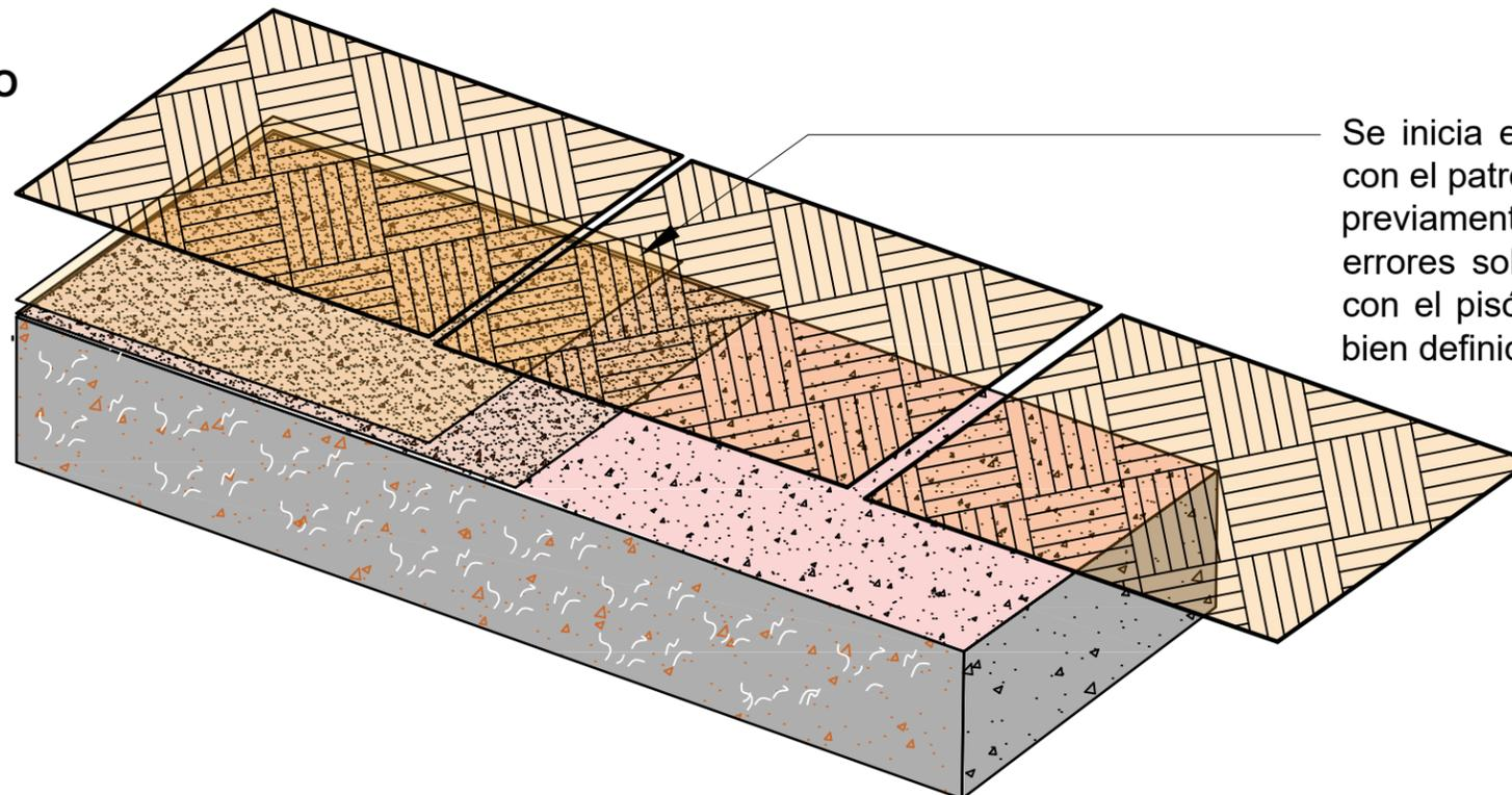
Se inicia el proceso de **ESTAMPADO** del concreto con el patrón del molde seleccionado, planeando previamente la distribución de los moldes para evitar errores sobre el concreto fresco. Se puede ayudar con el pisón para garantizar una textura profunda y bien definida.
